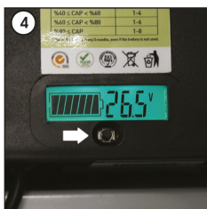
Battery voltage (20 - 26,6) Volt
